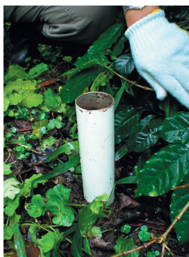
写真-1 土壌の透水性の測定(左)と硬度の測定(右)
